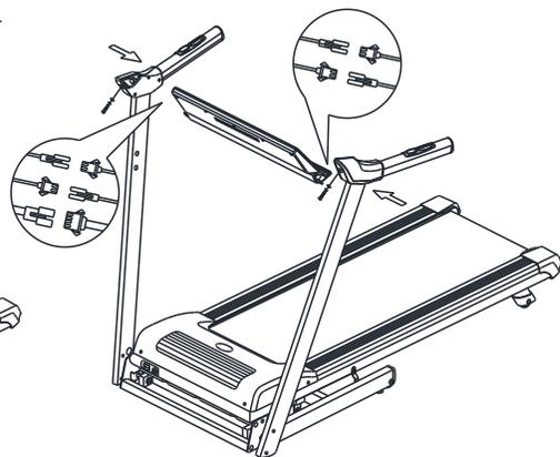
**第四步：拆下防跳装置。**将防跳装置上的紧固螺丝扭松并取下，收纳保管。然后将跑台折叠起来，若发现其不在左右扶手的中心位置，则松开前面步骤的螺丝，调整好跑台与扶手左右两边的距离相等后逐个拧紧螺丝。如下图所示：
