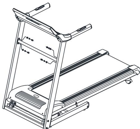
**第二步：安装电子表。**将立杆的控制线与电子表两端的控制线接好，然后将电子表两端插入到左右立杆内，再用 2 个 M6X25 圆柱头内六角螺丝带垫片、弹簧垫圈将表架固定在左右立杆上。注意：所有螺丝拧两圈即可，先不要拧紧。如下图所示：
