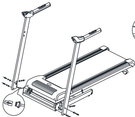
**第三步：安装立杆横管焊件。**将按摩头固定件两端孔位与左、右立杆孔位对准，然后用 4 个 M8X16 盘头内六角螺丝带垫片、弹簧垫圈拧上，这时将立杆、电子表及按摩头固定件上的螺丝逐个拧紧。如下图所示：
